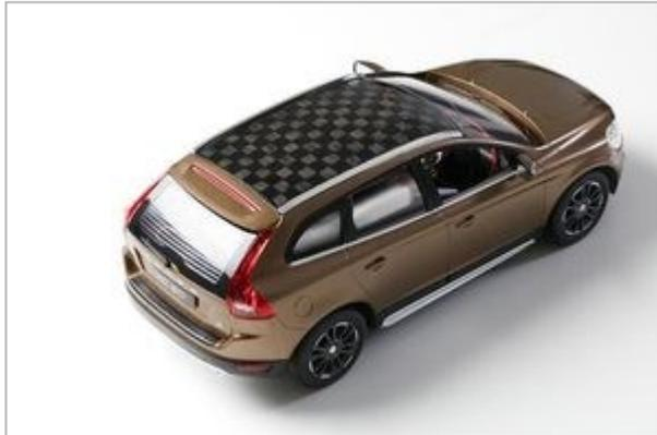
Abb. 1 - Prototyp mit nachhaltig gefertigtem Holzdach (Foto: [kth.se/en](http://kth.se/en))
