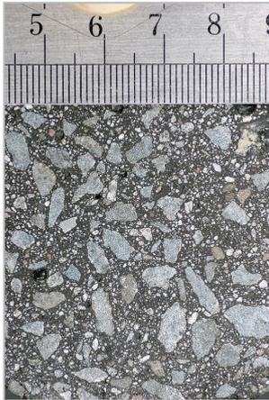
Abb. 1 - Querschnitt eines Gussasphalt 0/5,
