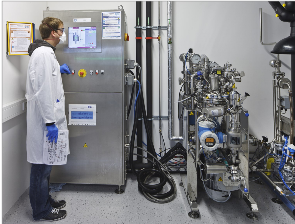
Abb. 1 – ZSW-Forscher mischt die Elektrodenpaste (Slurry) im Mischer. Bildquelle: ZSW / Solar Consulting GmbH
