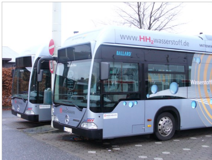
Mercedes-Benz Citaro Wasserstoffbusse in Hamburg mit Brennstoffzellen von Ballard (Bild: Torsten Pörschke)
