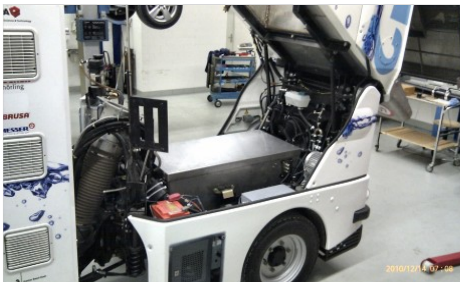
Abb. 5 - Brennstoffzellensystem des hy.muve-Projektfahrzeuges Bucher CityCat H2
