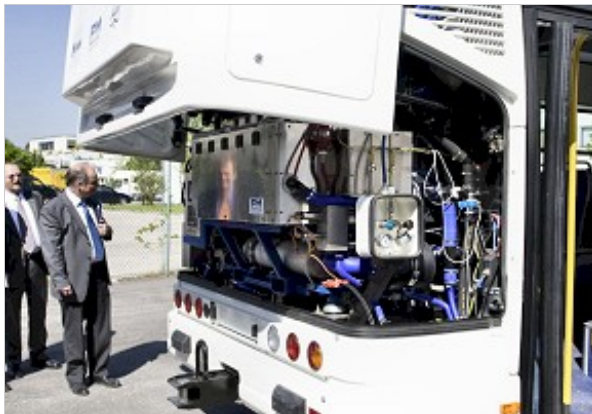
Triple-Hybrid-Brennstoffzellen-Aggregat im Heck des Busses.
