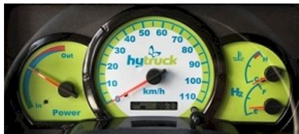
Oben: Hytruck 4 - Instrumente: Links: Power, Mitte: km/h, Rechts: Temperatur und H2-Tankanzeige
