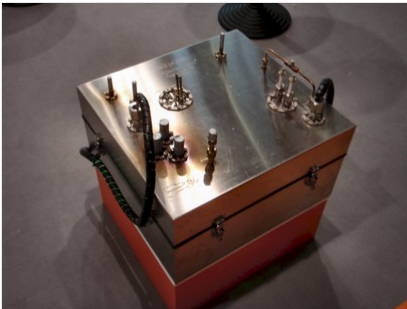
Brennstoffzellen-Stack von Topsoe AS, der in der BZ WFC 20 von Wärtsilä verbaut wird. Bild: Torsten Pörschke
