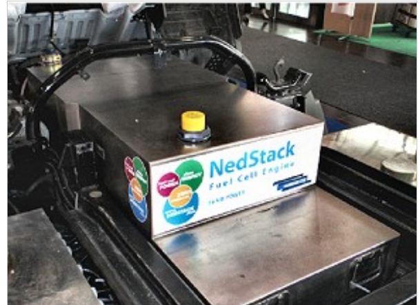
Bild 6: Brennstoffzelleneinheit von NedStack
