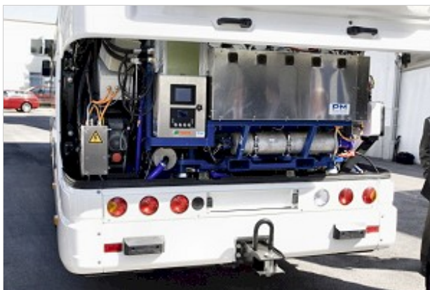
Das neue Triple-Hybrid-Brennstoffzellen- Aggregat im Heck des Busses.
