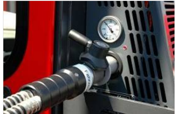
Oben: Tankstutzen, hier am Schlepper R 07-25 von STILL angeschlossen. Bild: http://www.h2gate.com , Barbara Makowka
