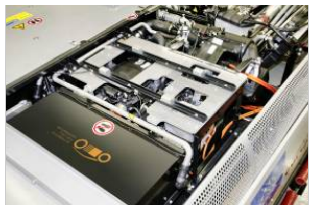
H2-Speichertanks und Technik auf dem Dach des Citaro FuelCell. Bildquelle: Daimler AG
