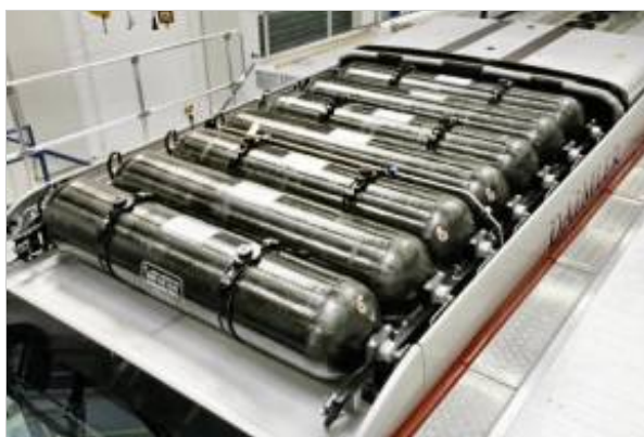
H2-Speichertanks und Technik auf dem Dach des Citaro FuelCell. Bildquelle: Daimler AG
