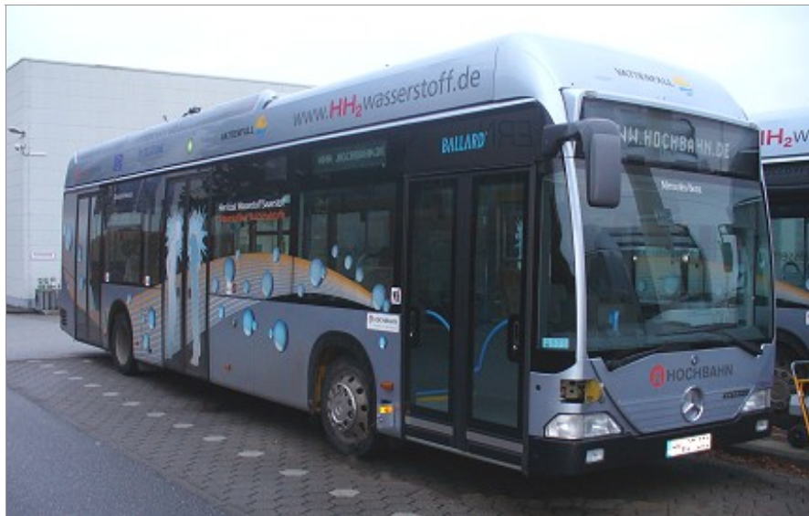
Mercedes Benz Citaro Wasserstoffbus in Hamburg mit Ballard-Brennstoffzellen (Foto: Torsten Pörschke)
