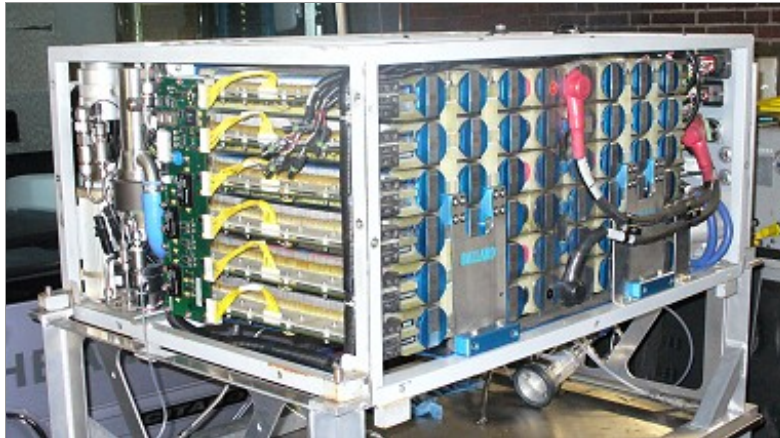
Brennstoffzellen eines Wasserstoffbusses (Hamburg, Torsten Pörschke)
