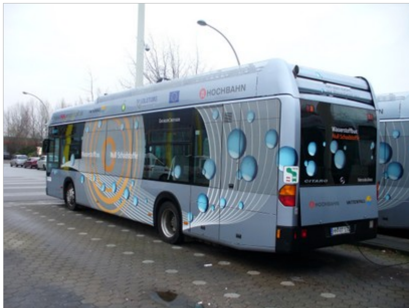
Mercedes-Benz Citaro Wasserstoffbus in Hamburg mit Ballard-Brennstoffzellen (Bild: Torsten Pörschke)
