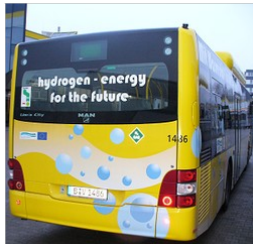
MAN Lion's City mit Wasserstoff-Verbrennungsmotor (Saugmotor) - Bild: Torsten Pörschke
